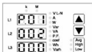
Przykład ustawienia współczynnika CT na 200 (1000 / 5)
